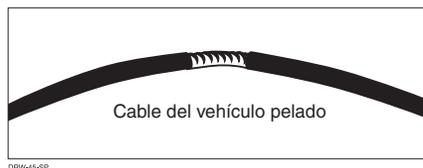
2. Retuerza el cable del módulo de seguridad alrededor de la sección desnuda del cable del vehículo.
